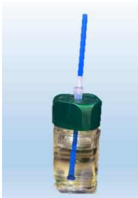
Рис. 2. Самодельный ареометр
